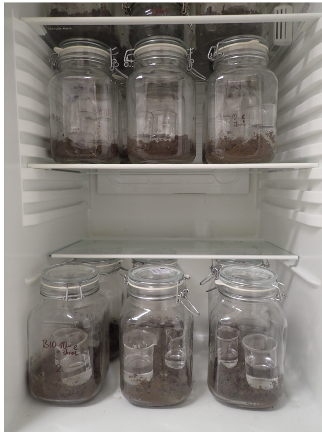
Příloha 3: Biodegradční pokus probíhající v termoboxu
