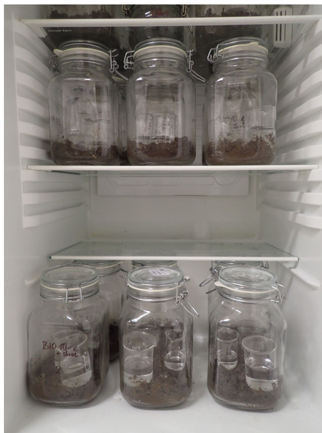
Příloha 3: Biodegradční pokus probíhající v termoboxu
