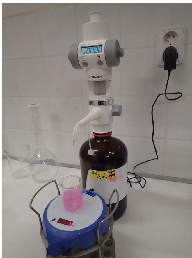
Příloha 4: Titrace zbytkového KOH po záchytu CO 2 uvolněného při mineralizaci
