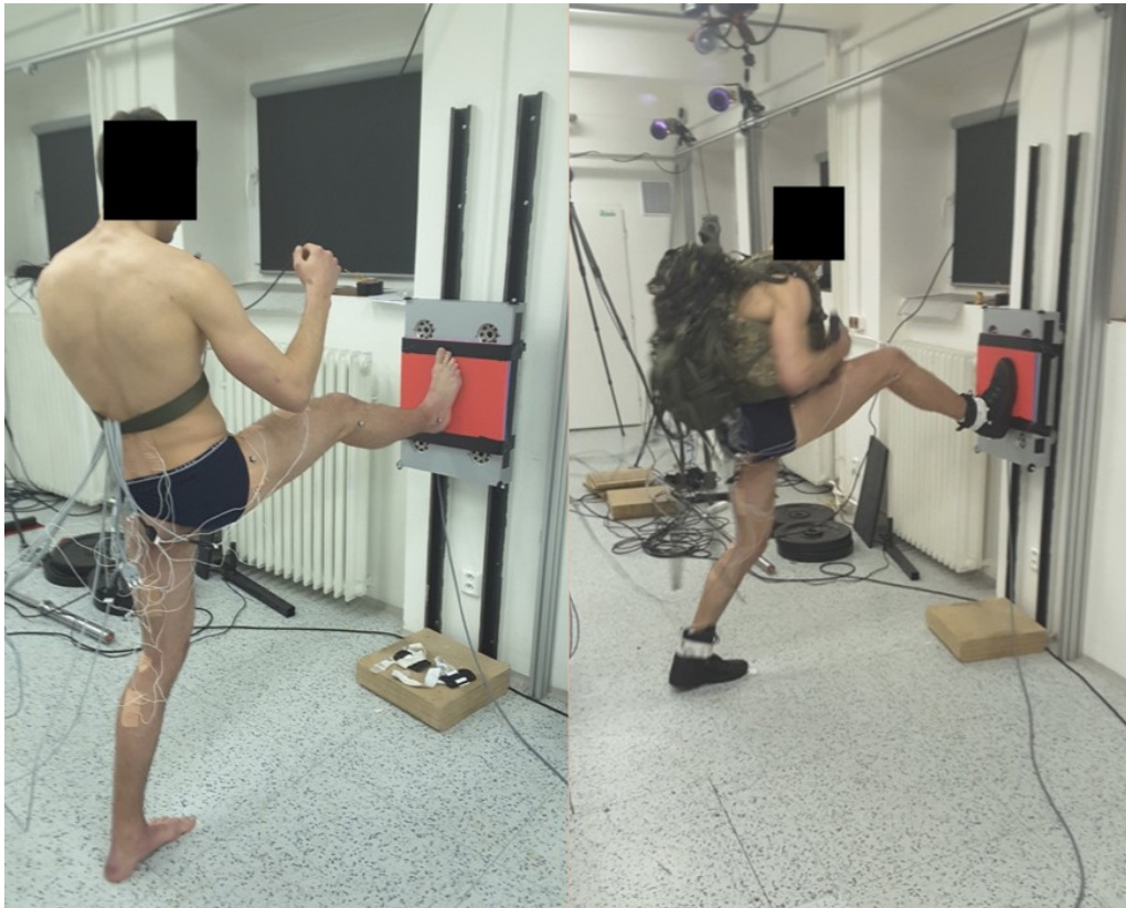
Obrázek 20 - Respondent v průběhu zasažení siloměrné desky (vlevo: bez zátěže, vpravo: se zátěží).
