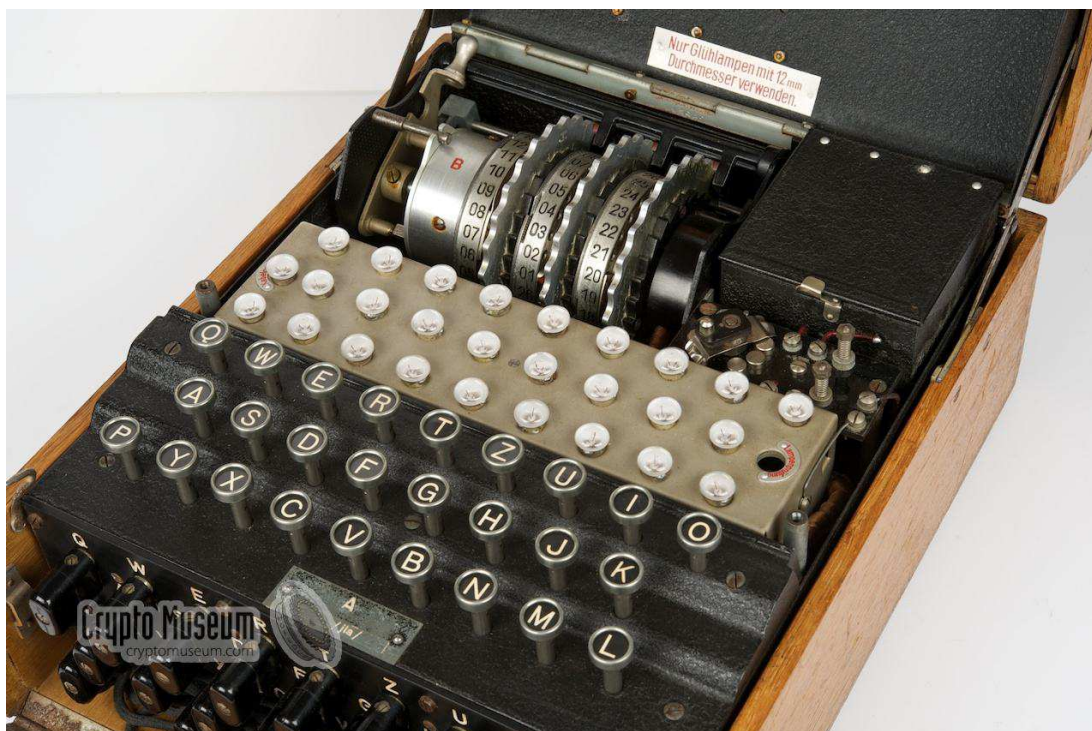
Obr. 1.3: Enigma s detailným záberom na vnútro a tri bubny. Zdroj (Reuvers a Simons, a)
