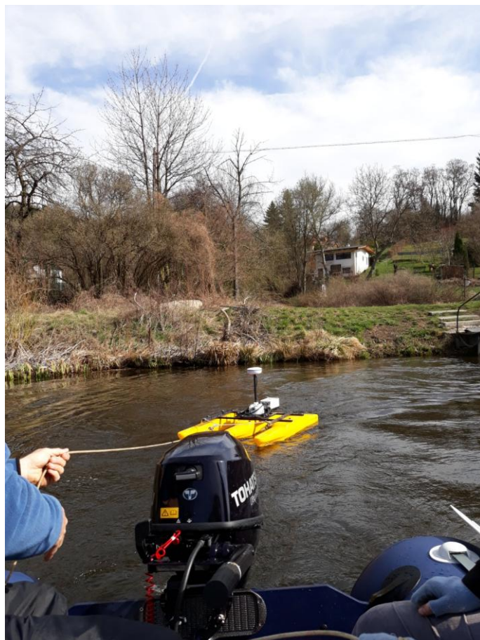
Obr. 12: Průběh měření – zařízení RiverSurveyor na plováku tažené motorovým člunem
