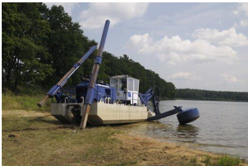
Obr. 1: Odbahnění vodní plochy pomocí plovoucího sacího bagru (zdroj: http://www.plosab.cz/c-16-saci-bagr-vasek.html )
