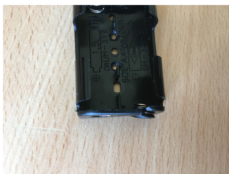
Obrázek 31: Poškozený držák - protavení plastového pouzdra
