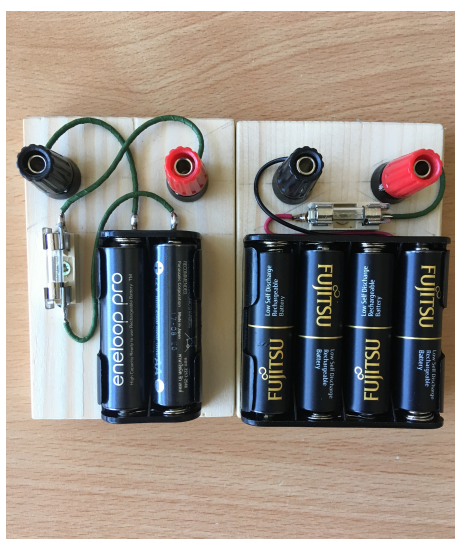
Obrázek 33: Zdroj napětí U_{Z1} vybavený pojistkou
