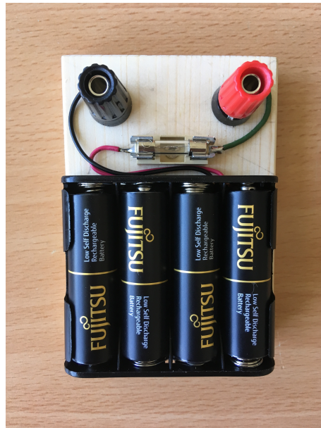
Obrázek 34: Zdroj napětí U_{Z2} vybavený pojistkou
