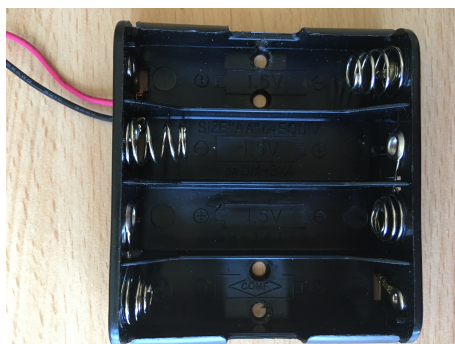
Obrázek 32: Poškozený držák - přehřátí kontaktních pružinek
