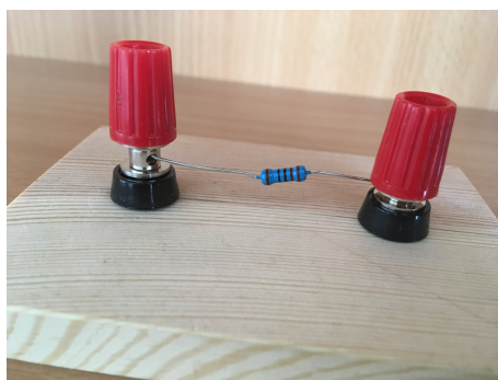
Obrázek 24: Rezistor v přístrojových svorkách
