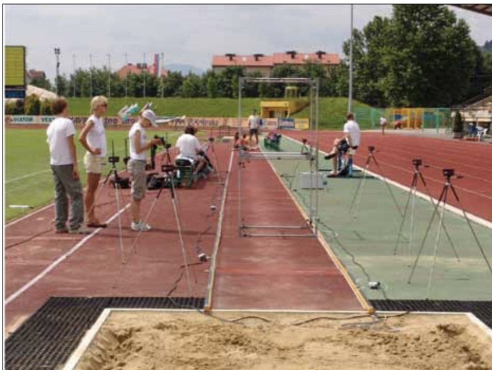
Obrázek 3: Postup měření pomocí technologie OPTO – TRACK a fotobuněk Brower Timing System (Čoh, Štuhec a Vertič, 2011)
