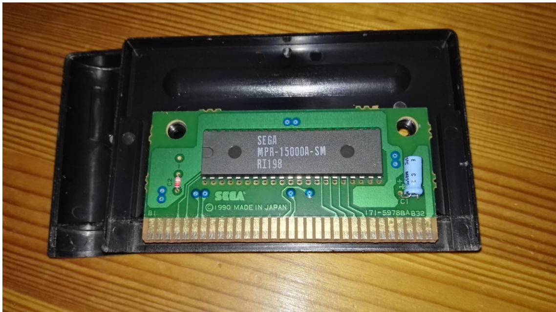
Příloha č. 2: tištěné spoje uvnitř „cartridge“/videoherní kazety(fotografie)
