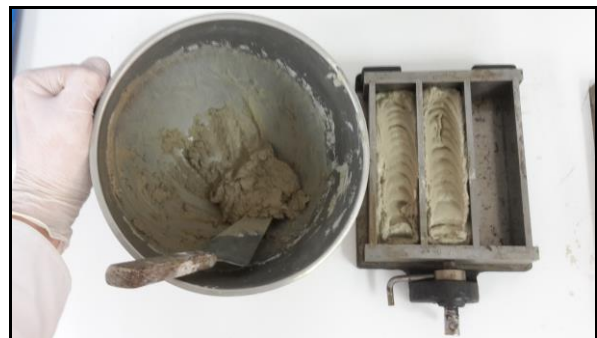
Obr. 4.12. Plnění rozmíchané maltové směsi do ocelové formy.
