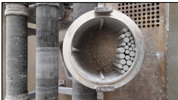
Obr. 4.6. Vzorek vypáleného materiálu umístěný v bubnu tyčového mlýnu.
