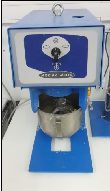
Obr. 4.10. Laboratorní míchačka Matest E094 použitá na přípravu maltových směsí.
