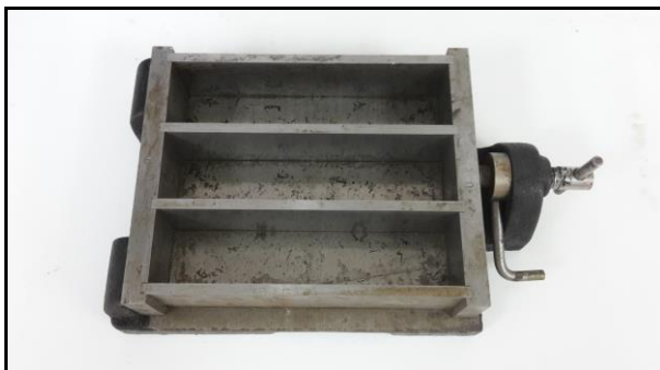
Obr. 4.11. Standardizovaná ocelová forma na přípravu zkušebních maltových trámců.
