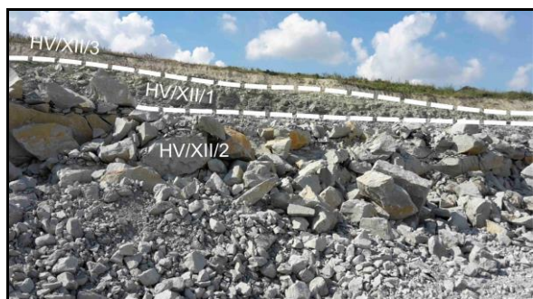
Obr. 3.33. Pohled na jihozápadní stěnu ložiska Úpohlavy (lom IV) od jihovýchodu s vyznačeným průběhem jednotlivých vrstev, kde byly odebrány vzorky HV/XII/1, HV/XII/2 a HV/XII/3
