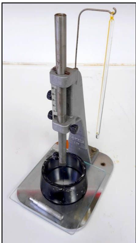
Obr. 4.8. Ručně ovládaný Vicatův přístroj společnosti Controls Group Company, model 63-L0028/1.
