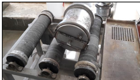
Obr. 4.7. Celkový pohled na zařízení tyčového mlýnu v průběhu drcení.
