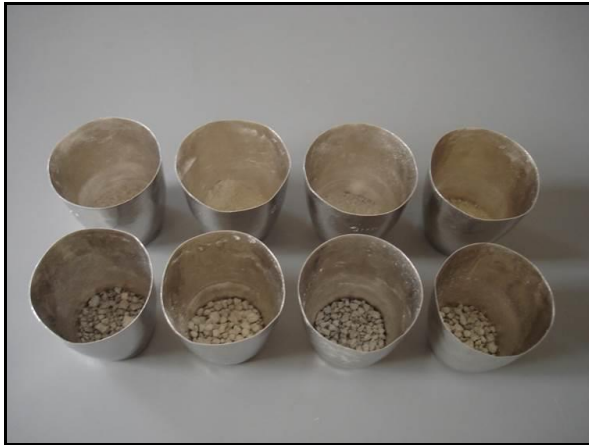
Obr. 4.3. Surovina v platinových nosičích před experimentálním výpalem v laboratorní peci.
