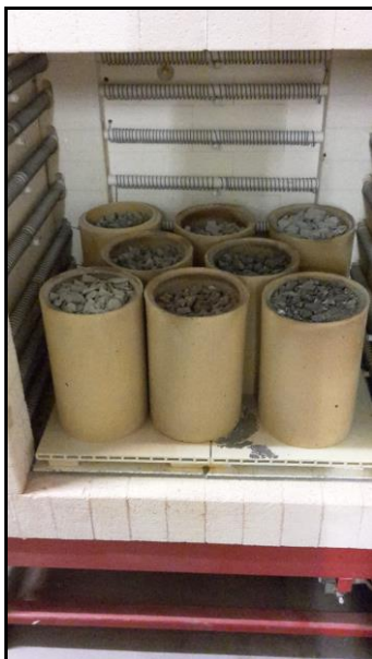
Obr. 4.5. Plnění pece před výpalem (vlevo) a pohled na naplněnou pec před začátkem výpalu (vpravo). Vypalované vzorky byly umístěny do šamotových trubek.
