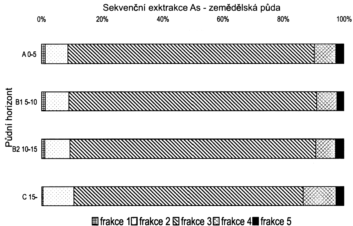
Obr. 12. Výsledky sekvenční extrakce pro horizonty zemědělského půdního profilu. Frakce Sb a As extrahované SEA: frakce 1 snadno dostupné; frakce 2 specificky adsorbované; frakce 3 amorfni a špatně krystalické oxyhydroxidy Fe a Al; frakce 4 krystalické oxyhydroxidy Fe a Al; frakce 5 residuální frakce.
