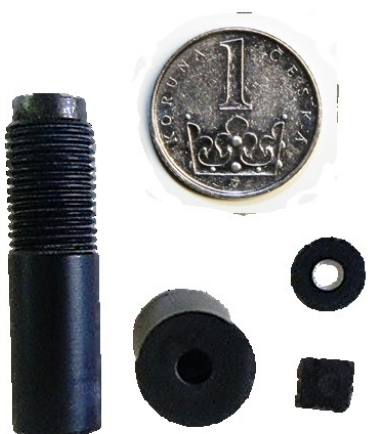
Obr. 2: Komerčně dodávané elektrodové tělo firmy NeoCoat. V pravém dolním rohu je přiložen používaný BDD film.
