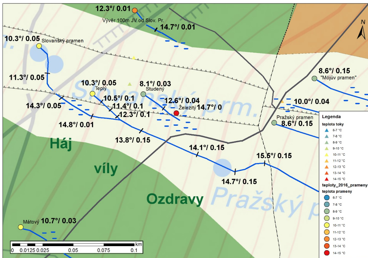
Obr. 11 Podrobná termometrie oblasti ukončení kvarcitového pruhu (zde zakrytý kvartérem) mezi Slovanským a Pražským pramenem mapovaná dne 27. 6. 2016. Údaje u pramenů či měření na toku vyjadřují teplotu vody ve °C a průtok v litrech za sekundu.
