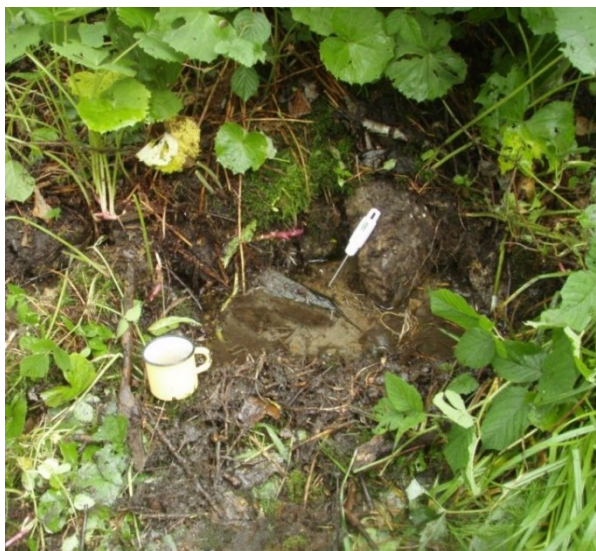
Obr. 12 Teplý pramen, divoký vývěr v oblasti mezi Slovanským a Pražským pramenem. Teplota 10.3 °C, průtok 3 l/min, aktivita 4 Bq/l 222 Rn (Foto Viktor Goliáš, 27. 6. 2016).
