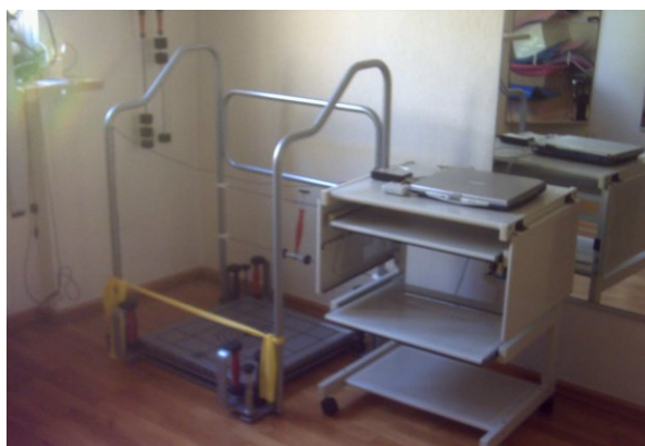
Obrázek č.3: Posturomed s připojeným akcelerometrem a vyhodnocovacím zařízením (Rašev, 2010)
