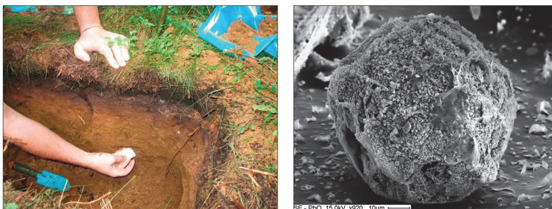
Obr. 7. Vkládání vzorku do půdy na počátku in situ experimentu (vlevo) (Ettler a kol. 2012b); Částice Pb oxidu s novotvořenými fázemi minerálů na jejím povrchu po 10 měsících inkubace ve vápenité písčité půdě na fotografii ze skenovacího elektronového mikroskopu (SEM) (vpravo) (Birkefeld a kol. 2007).
