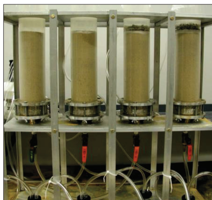
Obr. 5. Příklad laboratorního kolonového testu pro zjištění vyluhovatelnosti As z arsenolitu exponovaného v půdě (Yue a Donahoe 2009).
