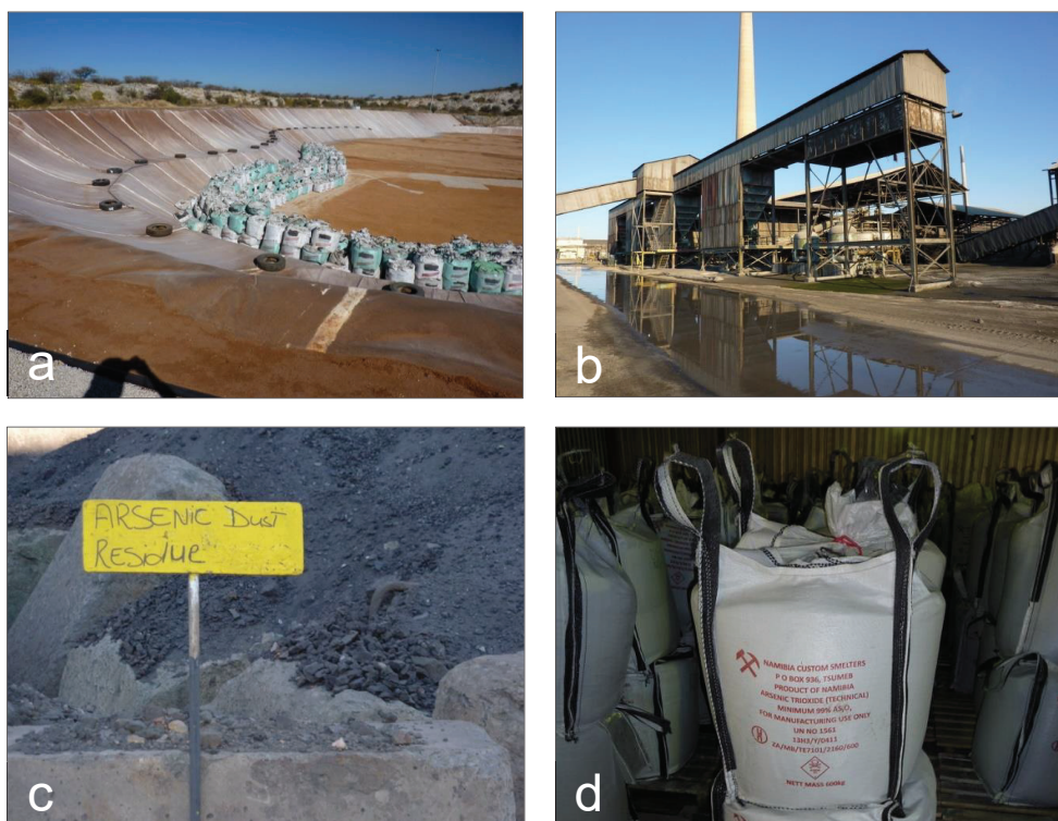
Obr. 13. Skládka pro As-bohatý popílek (a), zařízení na výrobu As_2O_3 (b), odpad z výroby As_2O_3 (c), čistý As_2O_3 připravený pro odběratele (d) (Tsumeb, Namibie) (foto: V. Ettler).
