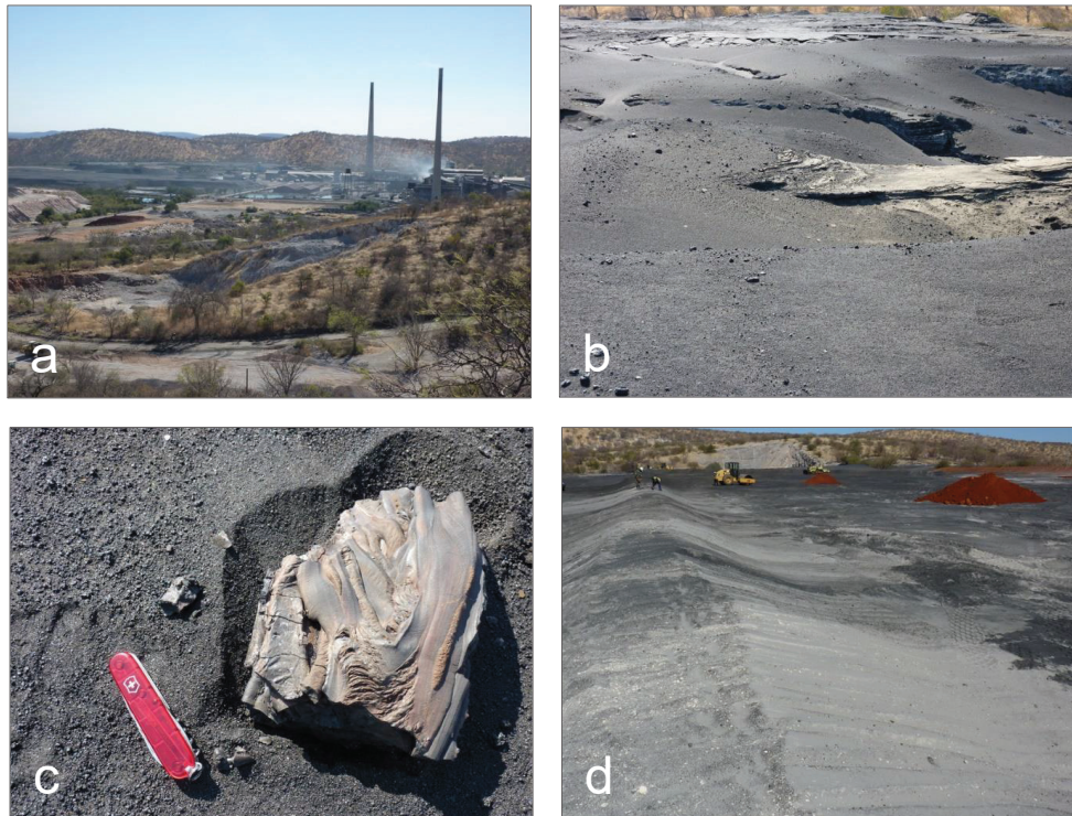
Obr. 12. Hut' na výrobu Cu (Tsumeb, Namibie) (a), granulovaná (b) a masivní (c) struska z pece typu Ausmelt na haldě, stabilizace strusky po flotaci (d), (foto: V. Ettler).
