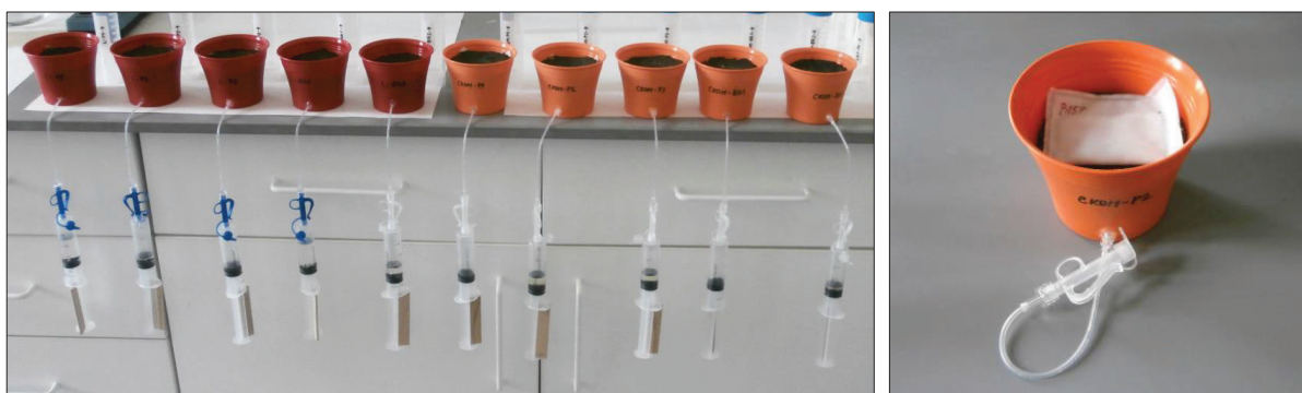
Obr. 16. Odběr pórových vod pomocí lyzimetrů typu Rhizon (vlevo) a umístění experimentálního sáčku s popílkem v nádobě před zahájením experimentu (vpravo) (foto: A. Jarošíková).
