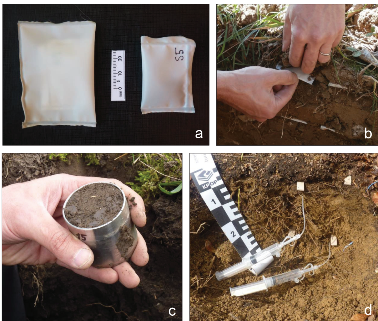
Obr. 17. Dvojité experimentální sáček (a), umístění sáčku se vzorkem do půdy (b), vzorkování půdy Kopeckého válečkem (c), odběr pórové vody z půdy pomocí lyzimetru (d) (foto: V. Ettler a A. Jarošíková).
