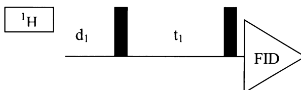
Obr. 19. Pulsní sekvence COSY-90 experimentu
