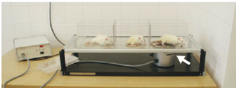
Obrázek 7: Přístroj používaný na Plantar Heater Test , kdy se měří latence odezvy zadní končetiny na zdroj sálavého tepla. Zdroj: Šedý et al. (2008)
