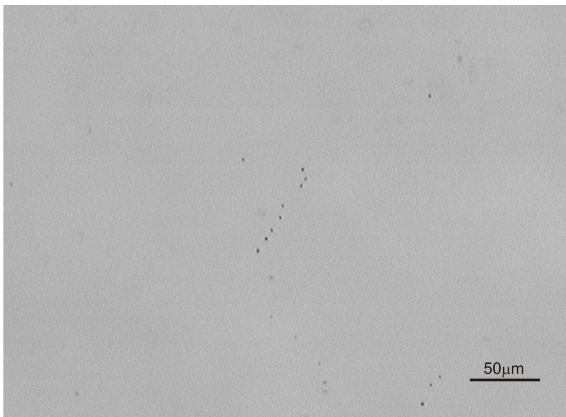
Snímka 9.1b: Snímka telúrových inklúzií po žíhaní v parách kadmia pri teplote 600°C po dobu 24 hodín, teplota v najchladnejšom mieste bola 500°C.
