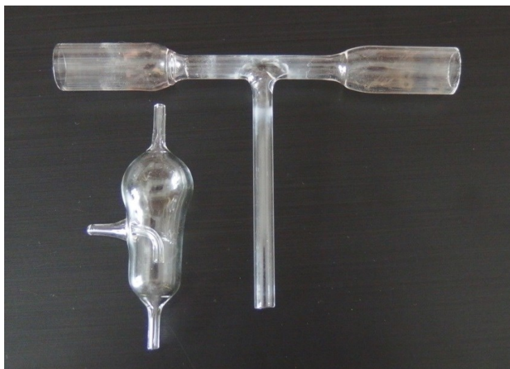
Obr. 3.2: Atomizátor a separátor fázi používaný ve spojení s QFAAS
