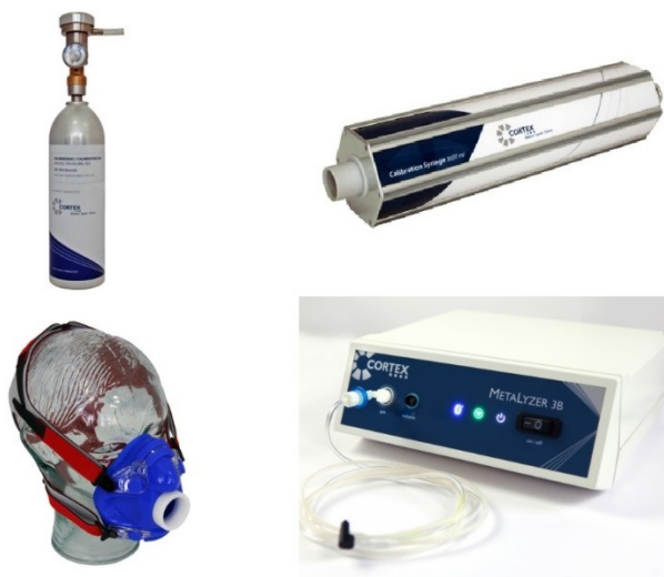
Obrázek 9 – Cortex MetaLyzer 3B + příslušenství (kalibrační plyn s ventilem, kalibrační pumpa, anatomická maska s čepičkou); zdroj: www.compek.cz
