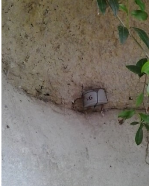
Obrázek 18: Měření výparu z volné hladiny, lokality uvnitř tafone pomocí PVC víček.
