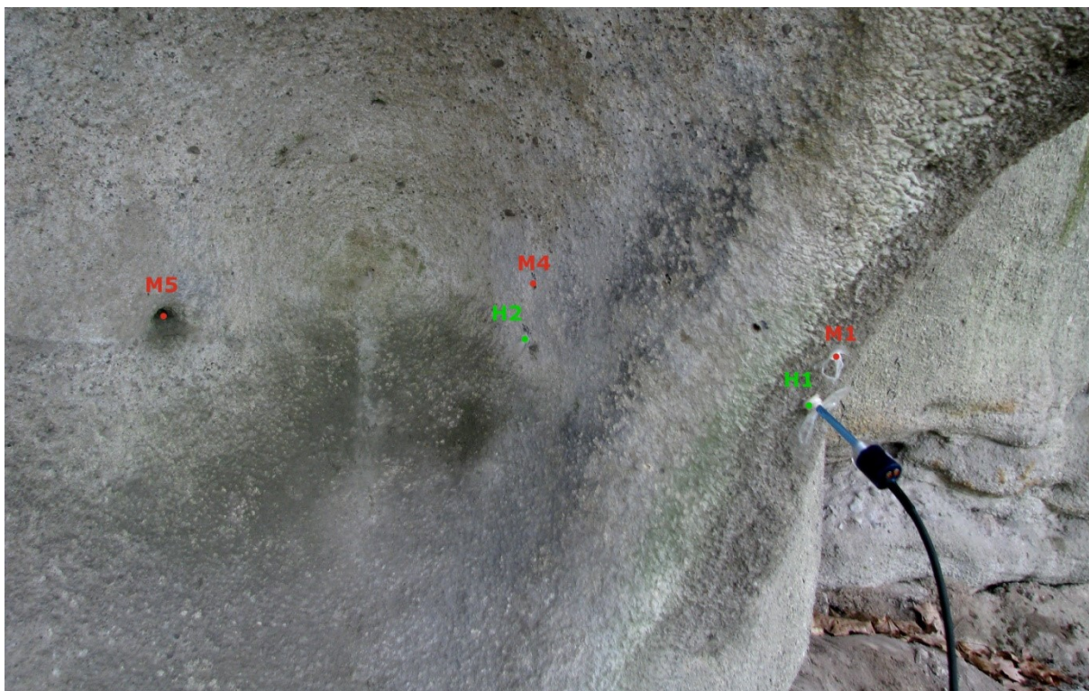
Obrázek 20: Měření sacího tlaku na profilu tafone na lokalitě Kr2. Situace měřených hlubokých (H) a mělkých (M) otvorů.
