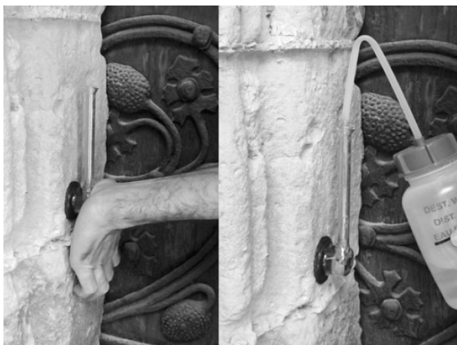
Obrázek 6: Použití Karsten tube pro měření rychlosti infiltrace v hornině nebo kameni. Podle Hendrickx (2013)
