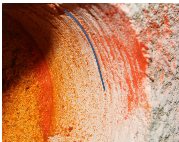
Obrázek 32: Hloubka výparové fronty na vizoru tafone (modře rozhraní vlhké a suché části)
