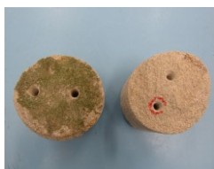
Obrázek 21: Jádra na měření retenčních křivek: dva vyvrtané otvory pro měření tenzometry.
