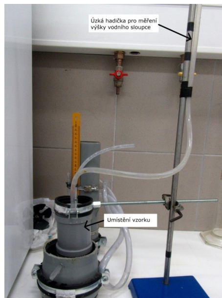
Obrázek 23: Propustoměr pro měření hydraulické vodivosti
