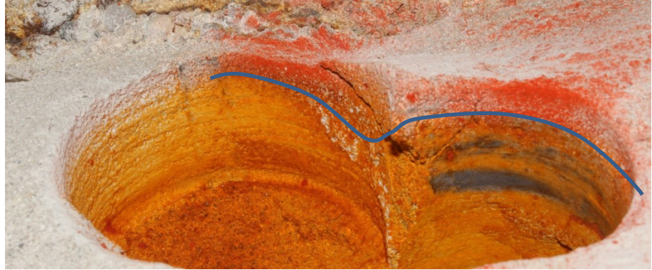
Obrázek 19: Měření hloubky výparové fronty pomocí fluoresceinu. (oranžovou barvou kapilární zóna, červeně suchý pískovec, výparová zóna modrou čarou)
