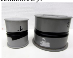
Obrázek 24: Měření retenčních křivek: homogenizace vzorků v PVC víčkách mezi jednotlivými kroky měření.
