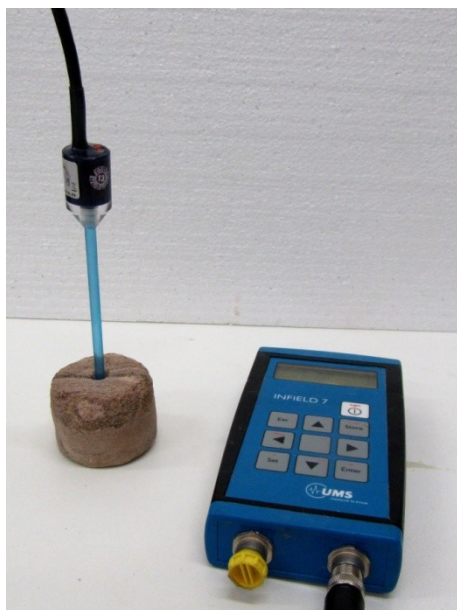
Obrázek 22: Měření tlaku tenzometrem T5x v laboratoři
