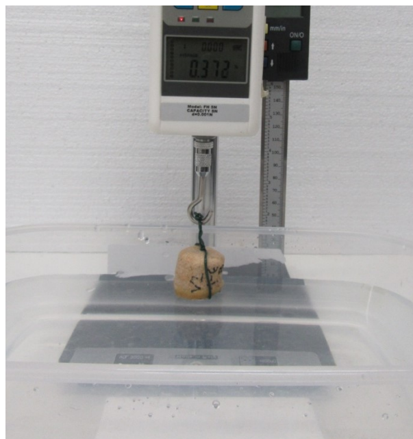
Obrázek 26: Kapilární nasákávání, uspořádání experimentu. Zavěšený vzorek má spodní plochu v kontaktu s vodou.
