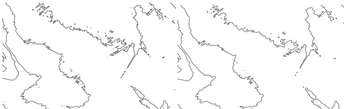
Obrázek 22: Srovnání vrstevnic z nevyhlazeného DMR (vlevo) a při aplikaci nízkofrekvenčního filtru o velikosti masky 3×3 (vpravo).
