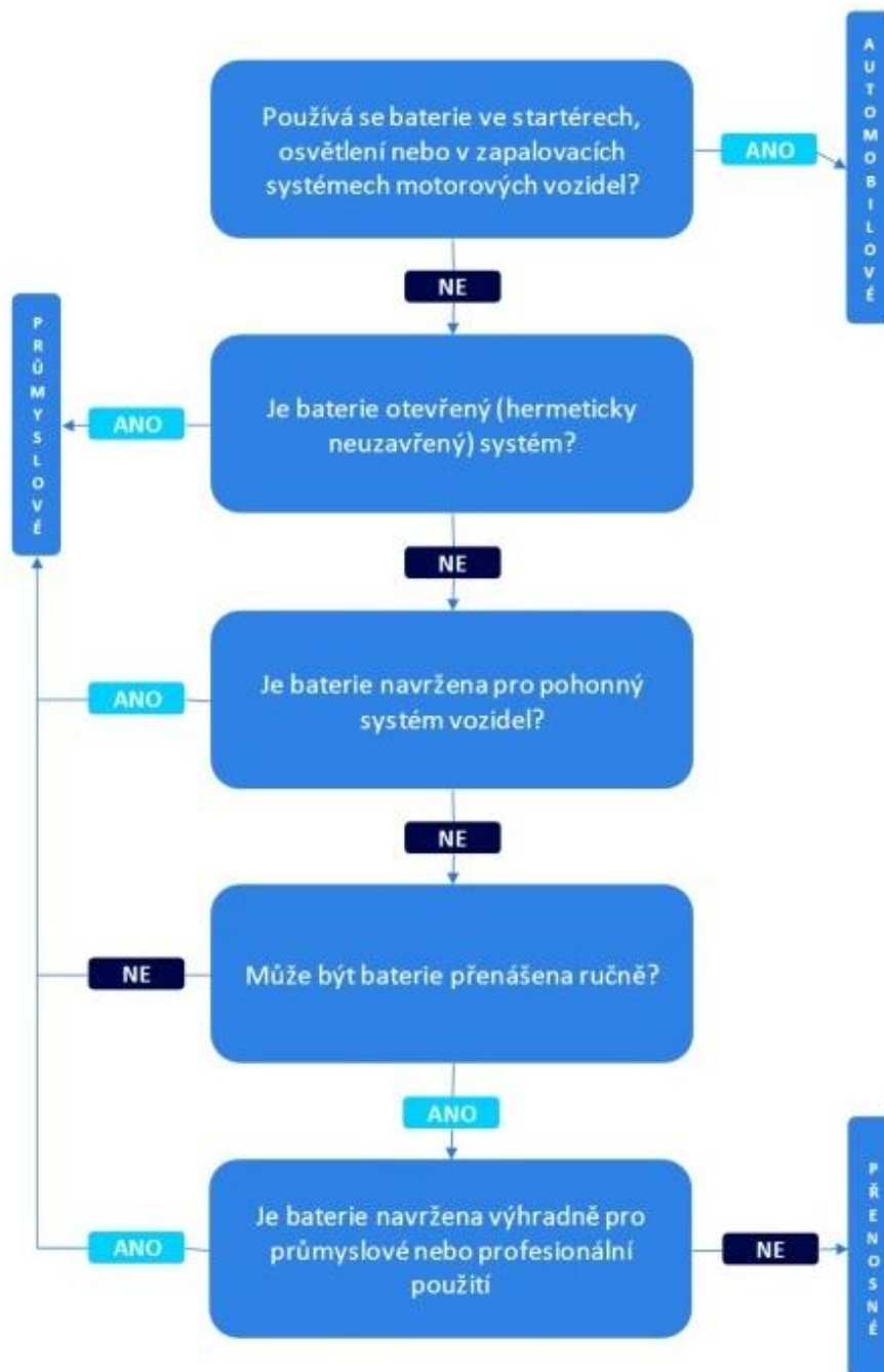
Obrázek 1 Schéma pro zařazení baterií (zdroj: Informace Odboru odpadů Ministerstva životního prostředí, k určení typu baterií či akumulátorů v praxi, 2017)
