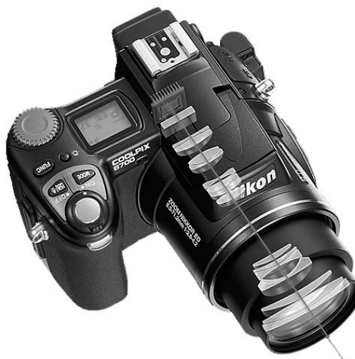
Obrázek 7. Průřez digitálním fotoaparátem ( http://www.fotoaparát.cz/image/6715 )
