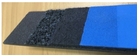
Obrázek č. 1 - Jednotlivé vrstvy pevného povrchu Casali (foto: autor textu, 2017)
