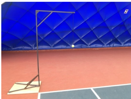
Obrázek č. 14 - Stojan na zavěšení tenisového míče 1m nad zemí (foto: autor textu, 2017)
