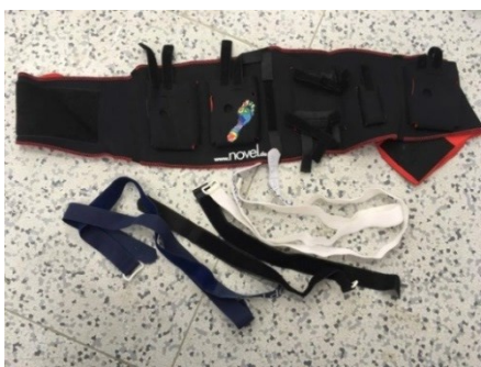
Obrázek č. 16 – Pásky na upevnění kabelů a bederní opasek na držení baterky a měřícího zařízení (foto: autor textu, 2017)
