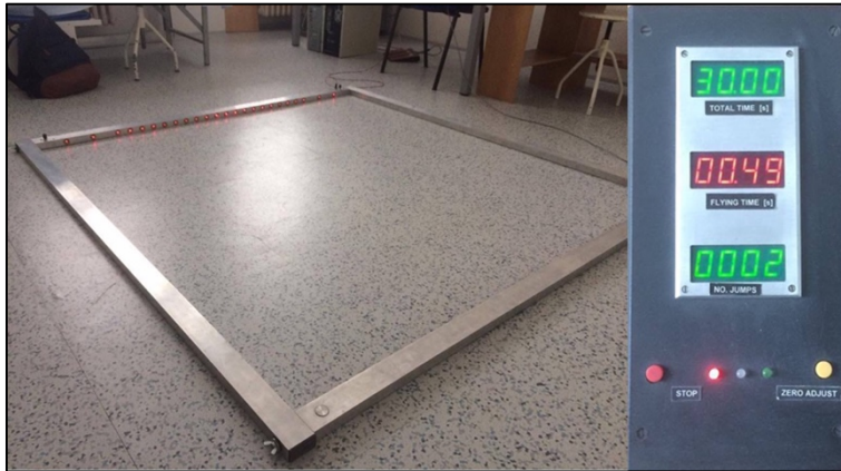
Obrázek č. 5 Výškový rám užitý pro měření Boscova testu opakovaných výskoků (archiv autora, 2017)
