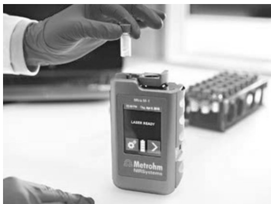
Obr. 11 Mobilní Ramanův spektrometr Metrohm Mira, převzato z [21]
