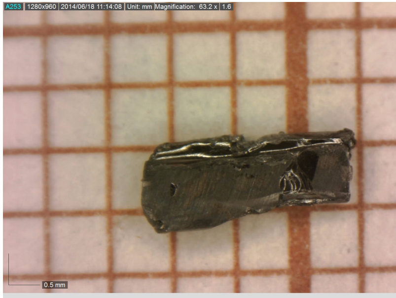
Obrázek 2.3: Obrázek odštípnuté fazety vzorku č. 7. Viditelný je obdélníkový tvar a větší matnost dána selenem.
