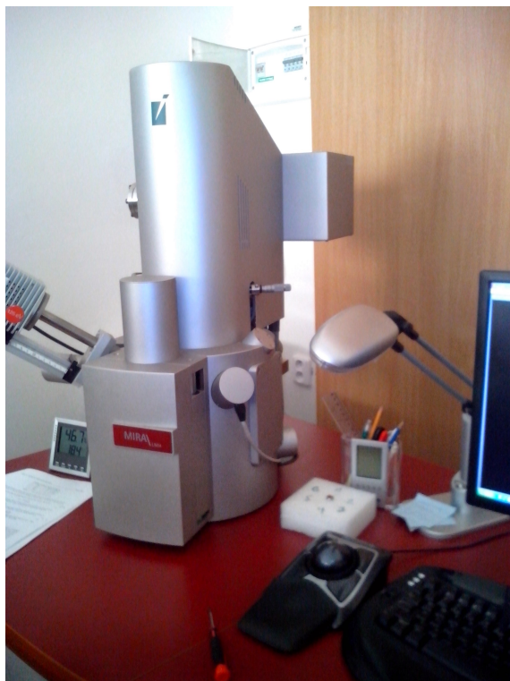
Obrázek 2.4: Elektronový mikroskop Mira 1 od firmy Tescan.
