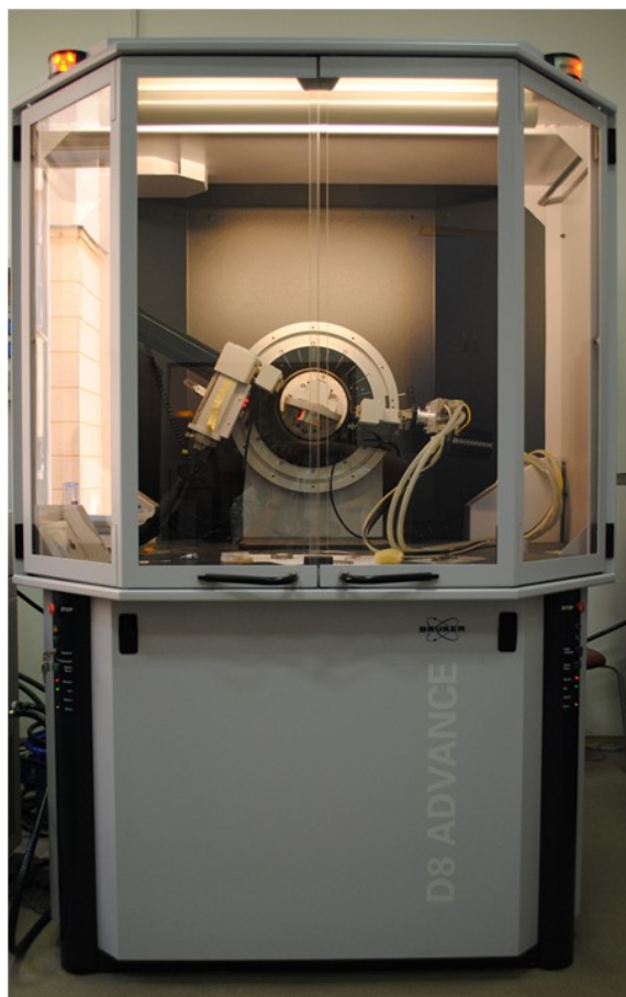
Obrázek 2.9: Difraktometr Bruker D8 Advance na KFKL.
