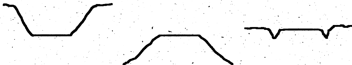
Obr č.1: Typický zářez, násep a rovina jako tři odlišné způsoby vedení komunikace.
