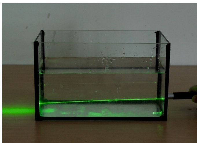
Obrázek 3.8: Mírné zakřivení laserového paprsku
