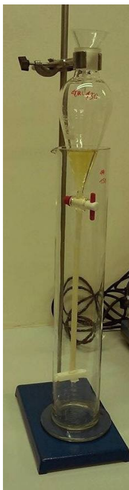
Obr. 3.1: Aparatura na HFD: Nálévka o objemu 250 mL je upevněná do stojanu. Na stopce nálevky je upevněno parafilmem dialyzační střevo, na konci zajištěno plastovou svorkou. Střevo je umístěno v odměrném válci, do kterého filtrát odkapává.
