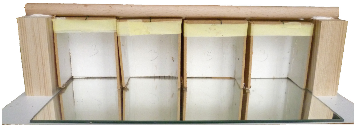
Obr. 5: 4-boxová aparatura s horizontálním zrcadlem.
