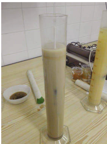
Obr. č. 13: Průběh hustoměrné zkoušky (vlastní dokumentace)
