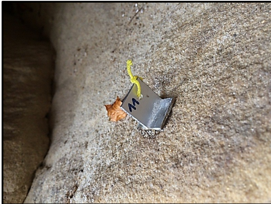
Obrázek 75. Hliníkový T–profil o rozměru 2 × 2 cm přilepený epoxidem ke skalnímu povrchu
