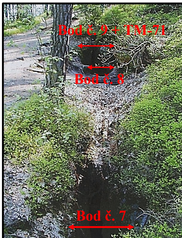
Obrázek 25. Monitorovaná bloková rozsedlina spolu s vyznačenými body měření; přístroj TM-71
