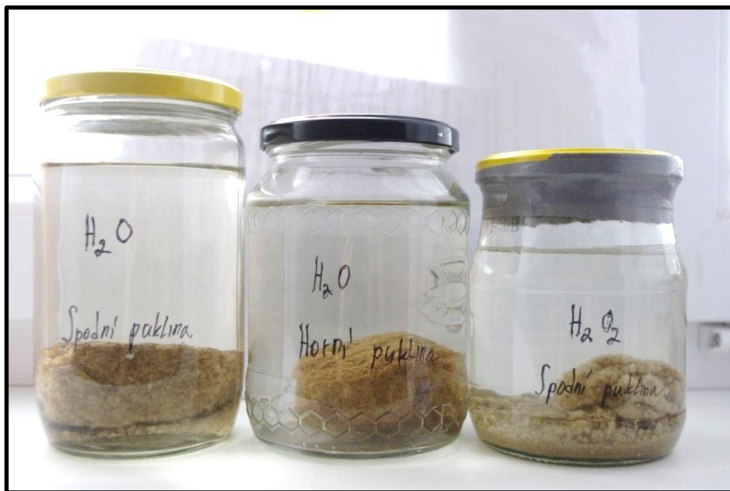
Obrázek 70. Vzorky pískovce ve vodě a v roztoku 30% peroxidu vodíku; dva vzorky zleva jsou ve vodě; vzorek na pravém okraji je v roztoku H 2 O 2 a je zřetelně vidět jeho rozpad
