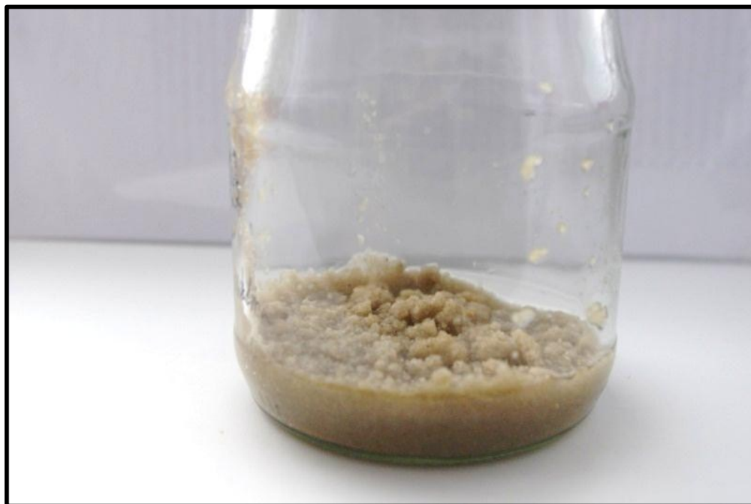
Obrázek 71. Vzorek pískovce rozpadlý při vylévání roztoku H 2 O 2
