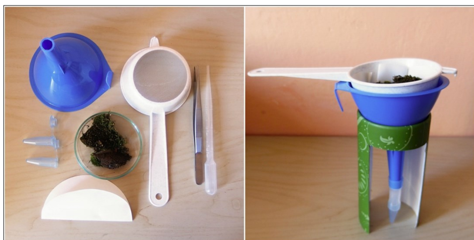
Obrázek 27: Improvizovaná Baermannova nálevka a vybavení potřebné k jejímu sestavení.
