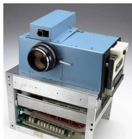
Obrázek č. 36: první prototyp digitálního fotoaparátu
