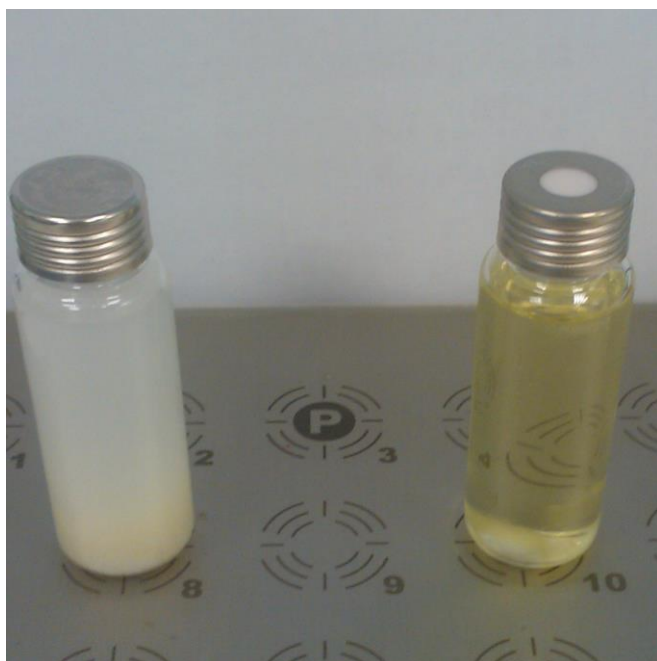
Obrázek 40 Makroskopicky pozorovatelný rozdíl v rozpouštění diosminu z mikronizované (vlevo) a nanovlákné formy diosminu (vpravo).
