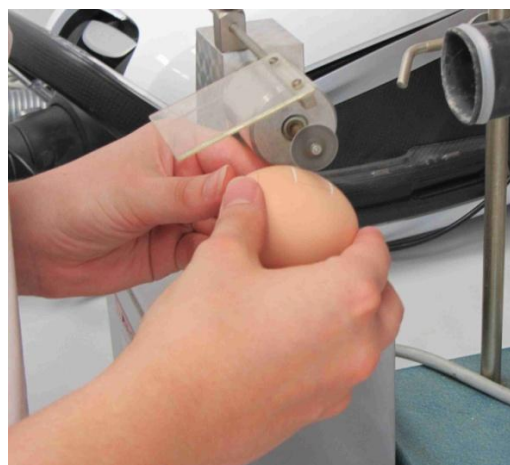
Obr. 6 Napilování okénka elektrickou bruskou.
