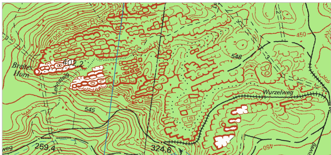
Obr. 81. Ukázka konturové metody. Oblast Labských pískovců, výřez z topografické mapy TK 10, v originále 1 : 10 000. Mapa: © GeoSN, 2016.
