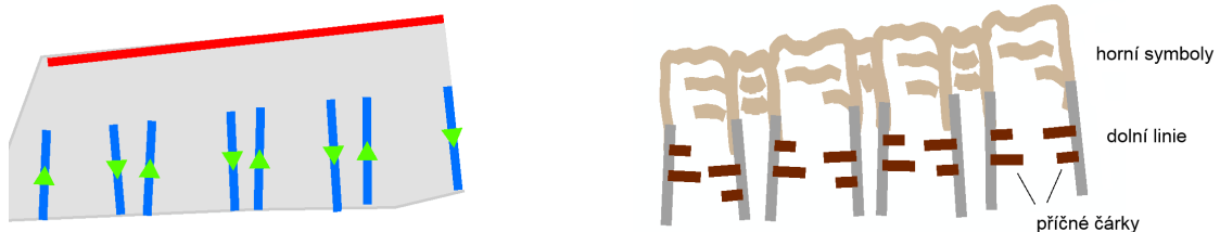
Obr. 100. Od linií ke šrafám metodou ZÚ. Vlevo šedě polygon objektu typu Skalní útvary , modře a červeně linie, které musí nakreslit kartograf. Červené linie jsou tvořené horními symboly, modré linie jsou dolní linie a zelené šipky znázorňují směr jejich nakreslení. Vpravo je výsledná reprezentace, jejíž jednotlivé části pro lepší názornost rozlišeny barvou. Podrobnější vysvětlení v textu. Zdrojová data: © ČÚZK, 2016.
