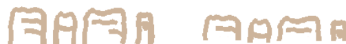
Obr. 101. Horní symboly připomínající části stylizovaných šraf. Vlevo skupina vyšších symbolů (pro širší linii), vpravo skupina nižších symbolů (pro užší linii). Vysvětlení v textu. Zdroj: ČÚZK (2011), upraveno.
