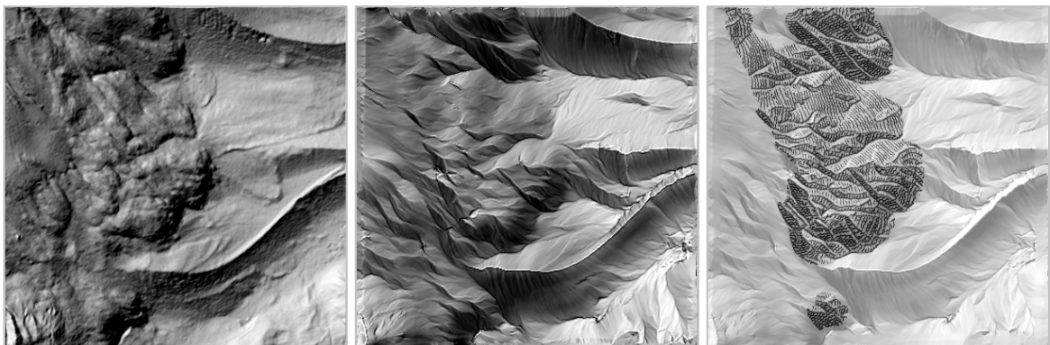
Obr. 126. Generování šraf metodou Geisthövel, Hurni (2015). Vlevo stínovaný model reliéfu, uprostřed generalizovaný stínovaný model po lokálním zvýšení kontrastu a přidání křivosti, vpravo výsledné šrafy (jen v oblastech, kde jsou skály, a na podkladě potlačeného stínování). Zdroj: Geisthövel & Hurni (2015).
