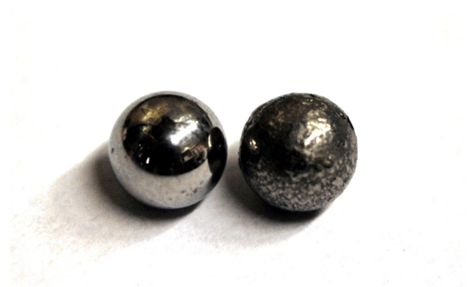
Obrázek 2.2: Efekt použití kyseliny stearové: vlevo čistá kulička po mletí s SA, vpravo pokrytá vrstvou Ti po mletí bez SA.
