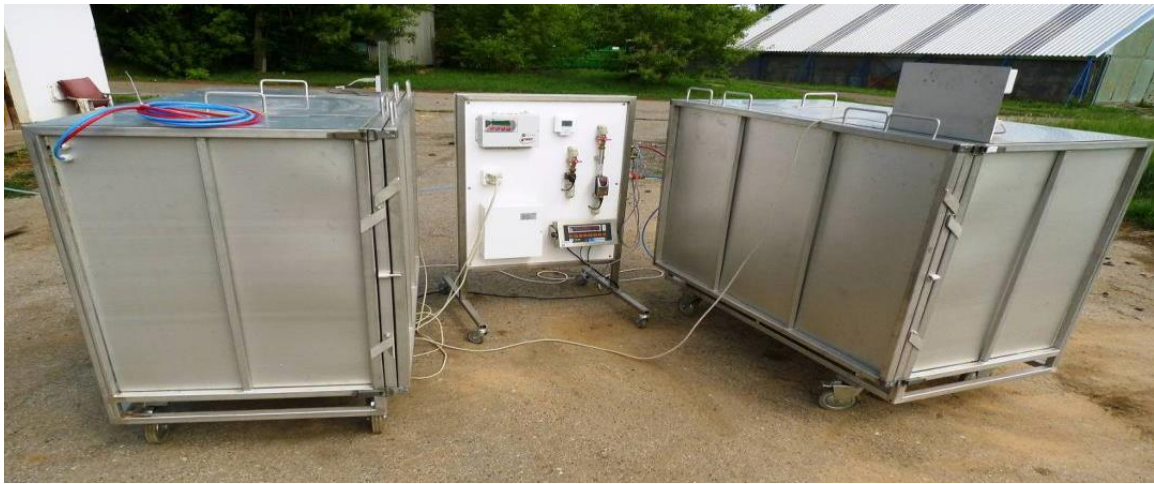
Obr. VI: Dvoumodulový vermireaktor [Hanč, Plíva, 2013: http://www.vuzt.cz/svt/vuzt/novinky/metodika2013pliva.pdf ]
