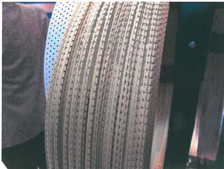
Obr. č. 29 – hrany lyží na stojanu, připravené do výroby (zdroj: www.esosport.cz 2005)
