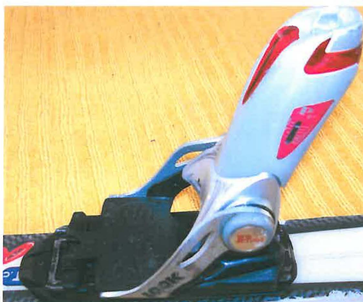
Obr.č. 66 – typické vázání firmy LOOK z 90. let 20. stol. – „komínově“ uspořádaná patní část ( i stupnice regulace hmotnosti lyžaře se nachází na komínu). Vázání firmy LOOK byla na přelomu tisíciletí nejpoužívanější mezi závodními lyžaři. (zdroj: archiv pí. Sanigové 2005)
