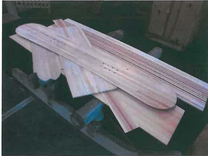
Obr. č. 28 - Dřevěná jádra pro lyže a snowboardy (zdroj: www.esosport.cz 2005)
