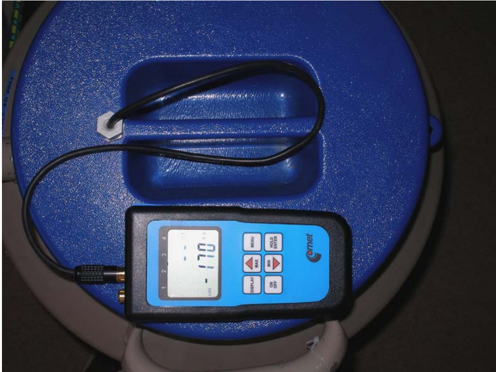
Obr. 7: Detail víka transportního kontejneru a registračního teploměru (COMET SYSTEM s.r.o.). Je vidět, že teplota uvnitř kontejneru je aktuálně -170^{\circ}\text{C} .
