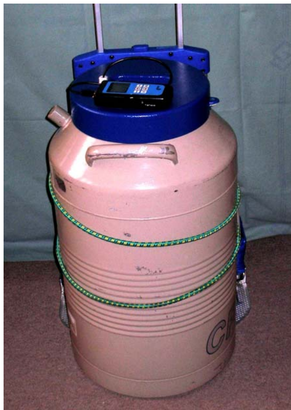
Obr. 6: Transportní kontejner (Transportní Dewarova nádoba CP 500, Tailor Wharton HARSCO) s možností měření teploty.
