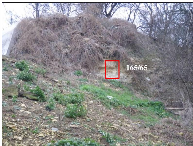
Obr. č. 11: Výchoz křídové opuky, 50 m pod ulicí Atletická, směr a sklon vrstev 165°/65, výška stěny 2,5 m
