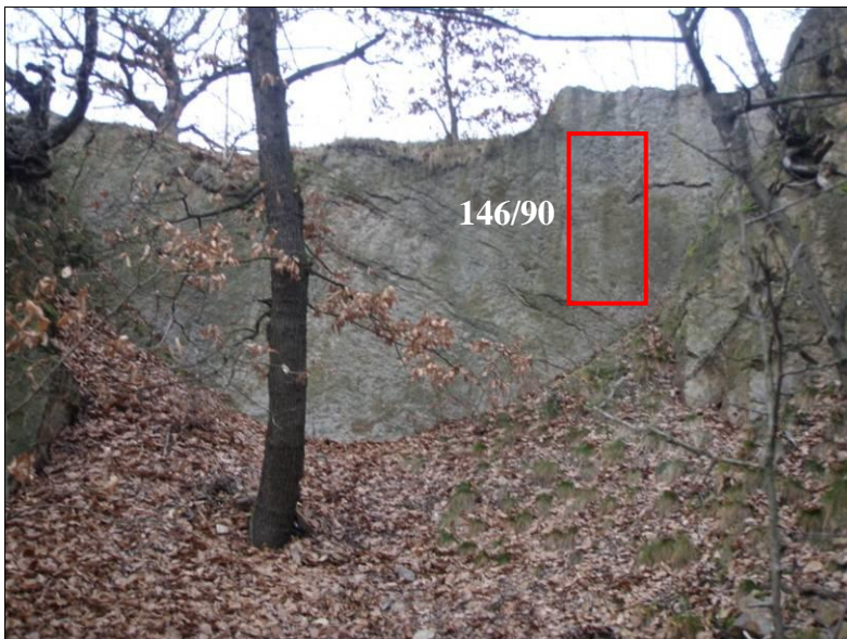
Obr. č. 8: Výchoz křemencový, starý lom 100 m S od stanice tram. Kotlářka, směr a sklon vrstev 146^{\circ}/90^{\circ} , výška stěny 3 m
