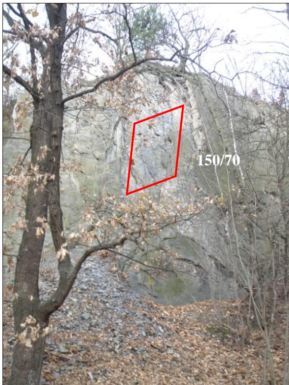
Obr. č. 4: Výchoz křemencový vysoký až 15 m, 200 m SZ od čerpací stanice; směr a sklon vrstev 150°/70°
