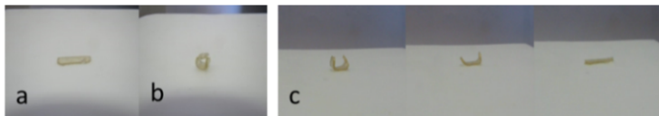
Obr.8 Tvarově-paměťový efekt epoxy-křemičitých nanokompozitů: a) původní tvar, b) ohřev, ohyb a zchlazení vzorku, c) znovu zahřátí až na T_d - 10s, 20s, 30s .
