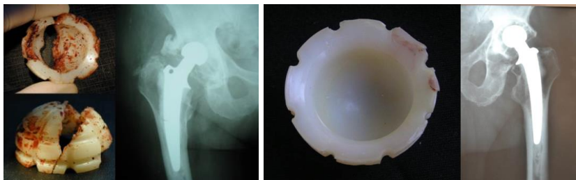
Obr. 1. Jamka Poldi/Beznoska explantována po 6,91 letech in vivo (implantována v roce 2002) s makroskopicky patrnou destrukcí a známkami opotřebením na fotografiích a RTG snímku (vlevo) a jamka Poldi/Beznoska explantována po 24,8 letech in vivo (implantována v roce 1986) s makroskopicky minimálními známkami opotřebením na fotografii a RTG snímku (vpravo)
