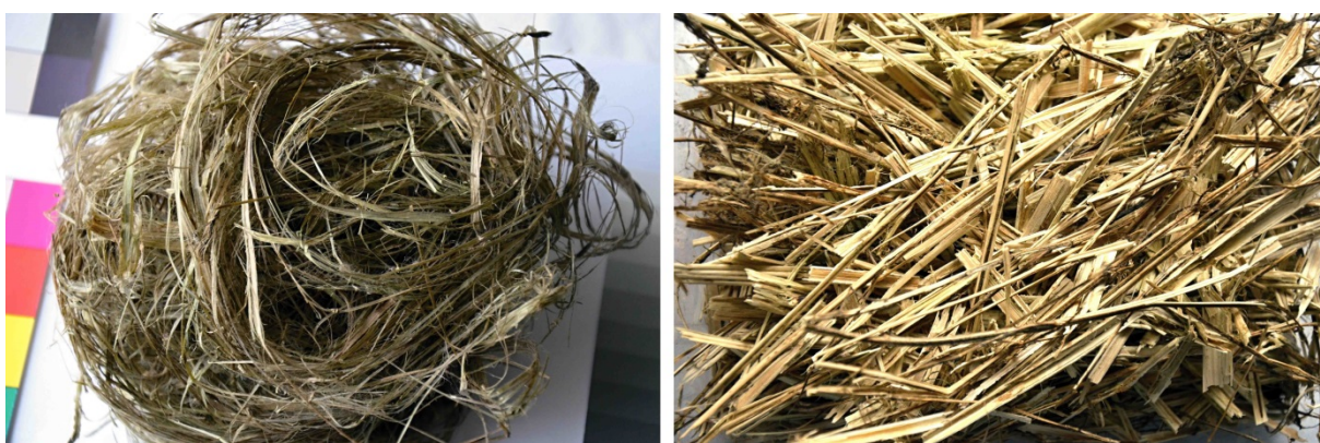
Obr. 54. Vlevo vlákna získaná z 18 kopřiv; vpravo oddělené pazdeří.
