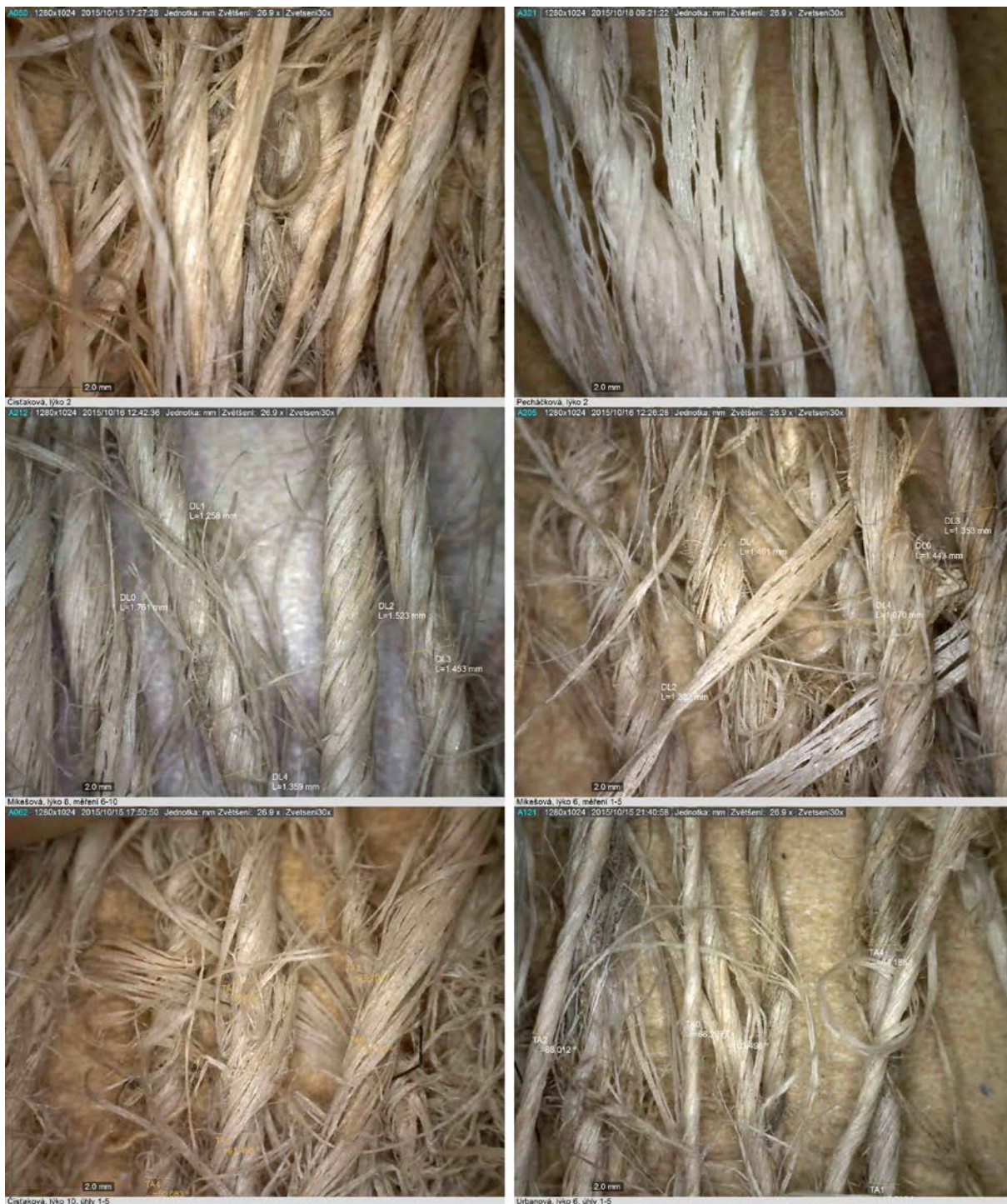
Obr. 68. Ukázky sepředených lýkových vláken různých přádelen na mikrofotografiích, pořízených v programu DinoCapture 2.0 ve třicetinasobném zvětšení. Na některých snímcích naznačeno měření tloušťky vláken či úhlu zákrutu.
