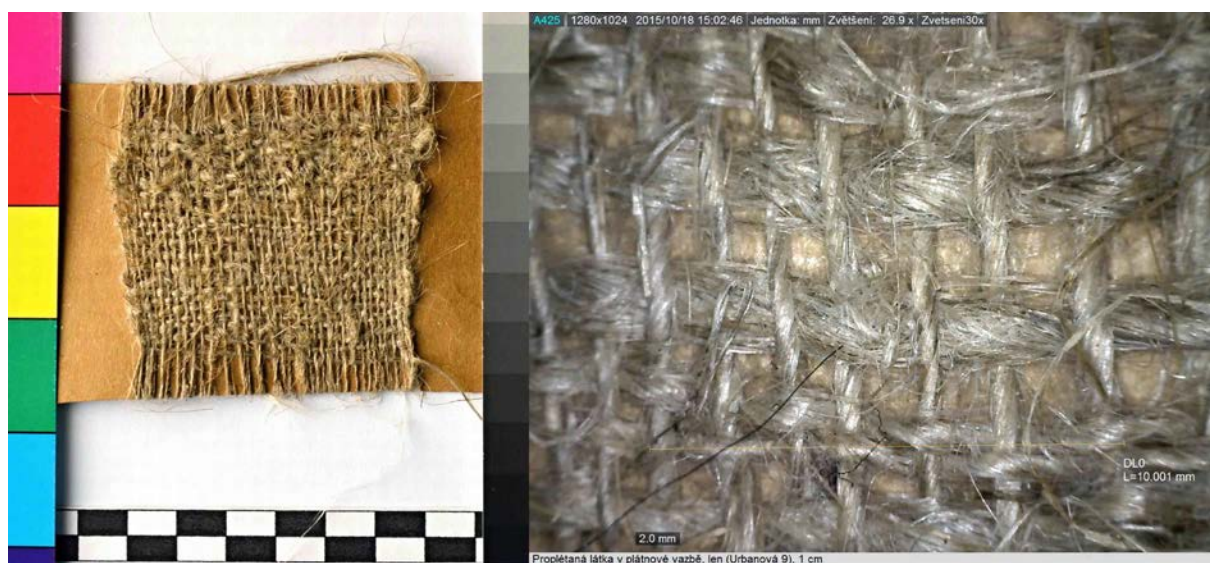
Obr. 65. Zkušební vzorek lněné látky v plátnové vazbě; vpravo mikrofotografie s označením počtu vláken/cm, pořízená v programu DinoCapture 2.0 ve třicetinasobné zvětšení.
