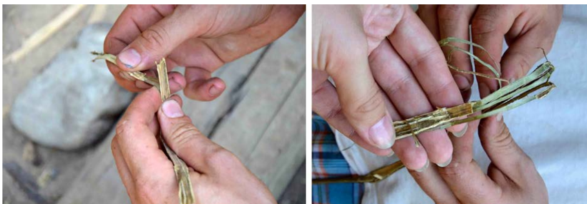
Obr. 53. Oddělování kopřivových vláken od pazdeří.
