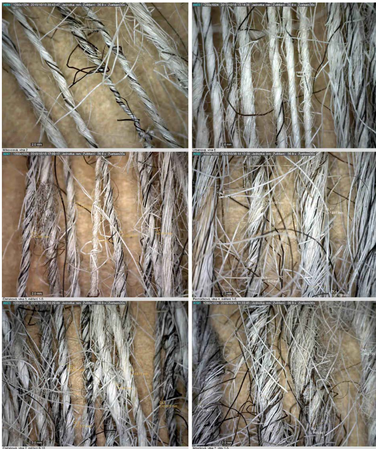
Obr. 66. Ukázky sepředených vlněných vláken různých přádelen na mikrofotografiích, pořízených v programu DinoCapture 2.0 ve třicetinasobném zvětšení. Na některých snímcích naznačeno měření tloušťky vláken či úhlu zákrutu.
