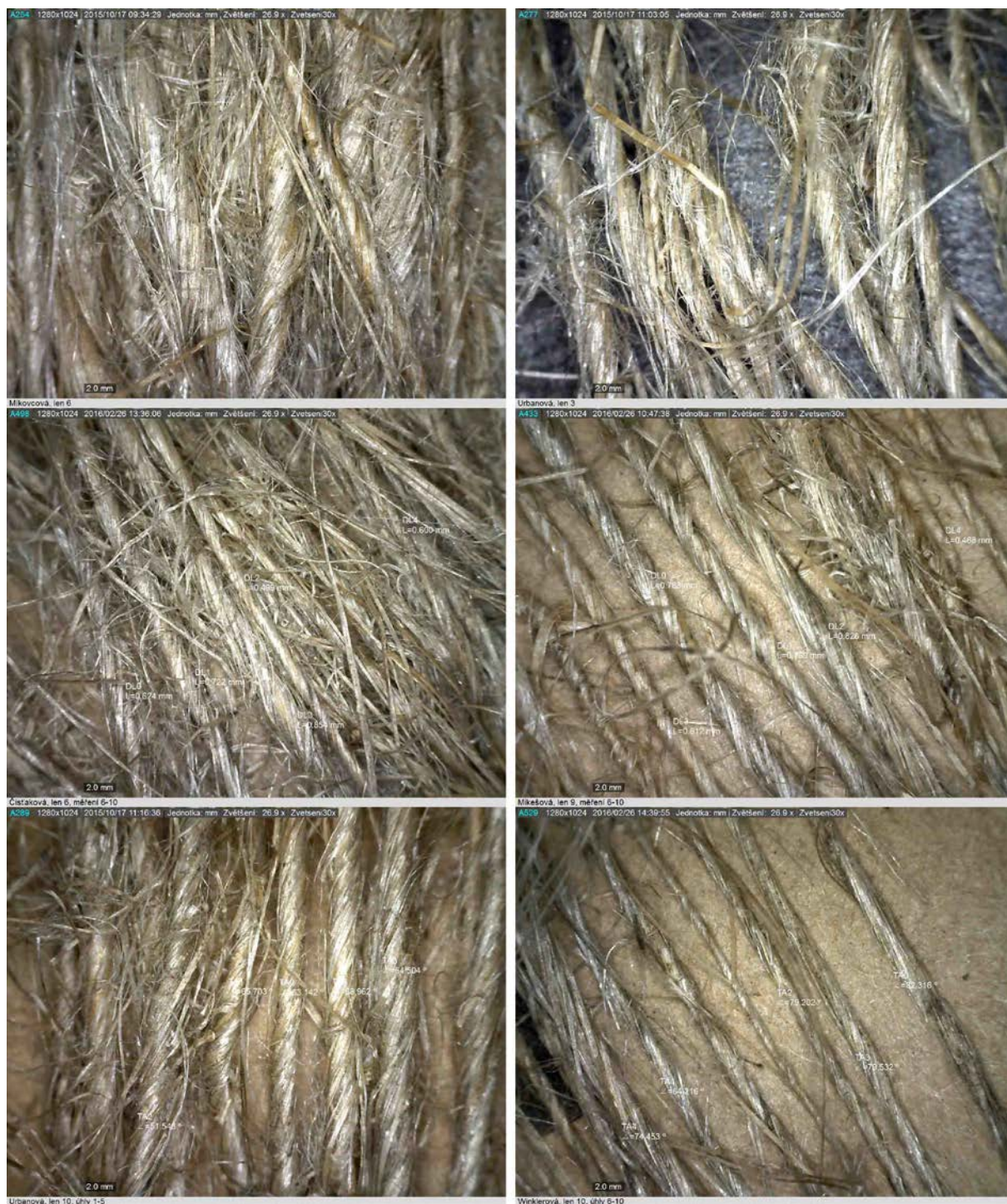
Obr. 67. Ukázky sepředěných lněných vláken různých přádelen na mikrofotografiích, pořízených v programu DinoCapture 2.0 ve třicetinasobném zvětšení. Na některých snímcích naznačeno měření tloušťky vláken či úhlu zákrutu.
