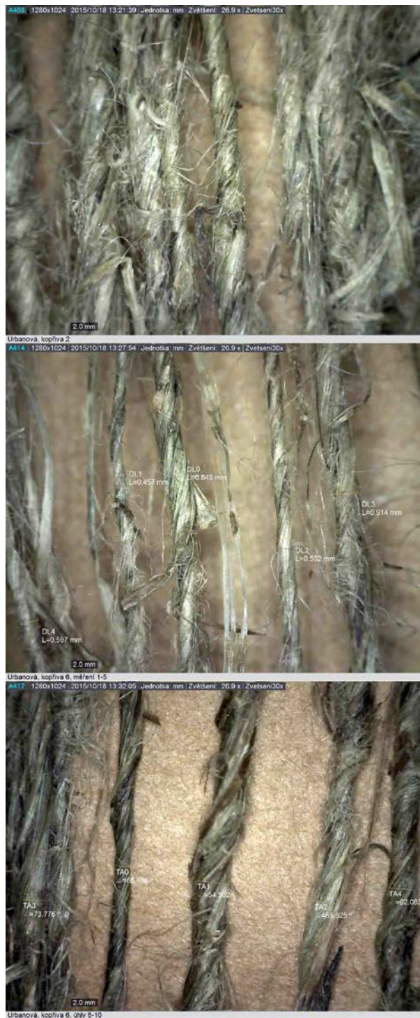
Obr. 69. Ukázky seředených kopřivových vláken na mikrofotografiích, pořízených v programu DinoCapture 2.0 ve třicetinásobném zvětšení. Naznačeno měření tloušťky vláken a úhlu zákrutu.
