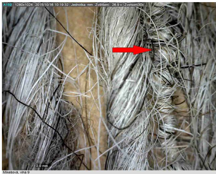
Obr. 73. Vlněné vlákno přadleny V. Mikešové: vyznačen tzv. přetočený zákrut.
