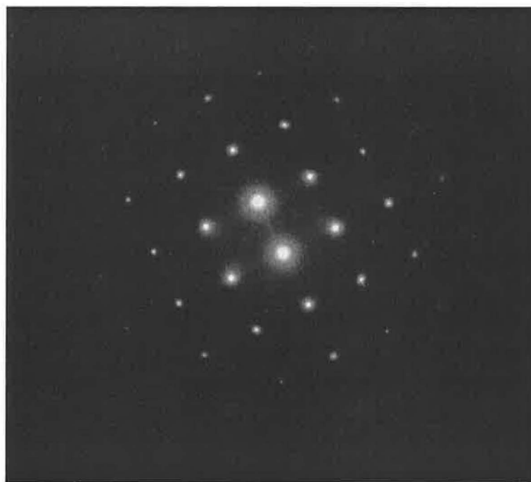
Obrázek 6.17: Obraz elektronové difrakce ve slitině AlCu 4 SiSnBi po izochronním žihání do 160 °C.
