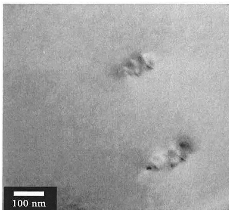
Obrázek 6.19: Snímek slitiny AlCu 4 MgSiPb po izochronním žhání do 180 °C. V matici nelze pozorovat výskyt nových precipitátů.
