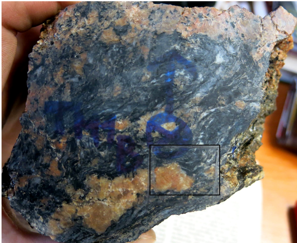
Obr. 15: Vzorek TMI – B. Obdélník značí oblast, ze které byl vyhotoven výbrus.
