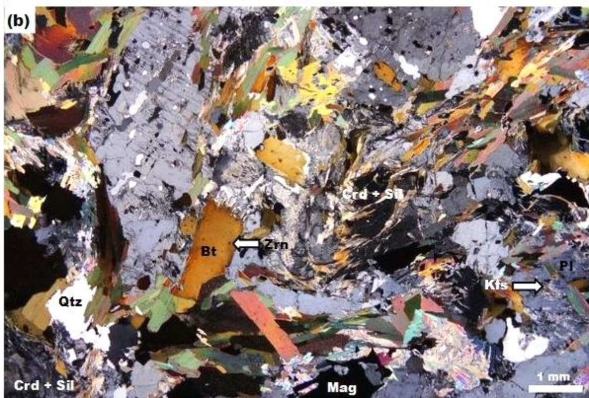
Obr. 28: Fotky z výbrusu TM2 – C. a) pozorování při jednom nikolu; b) pozorování s dvěma nikoly.
