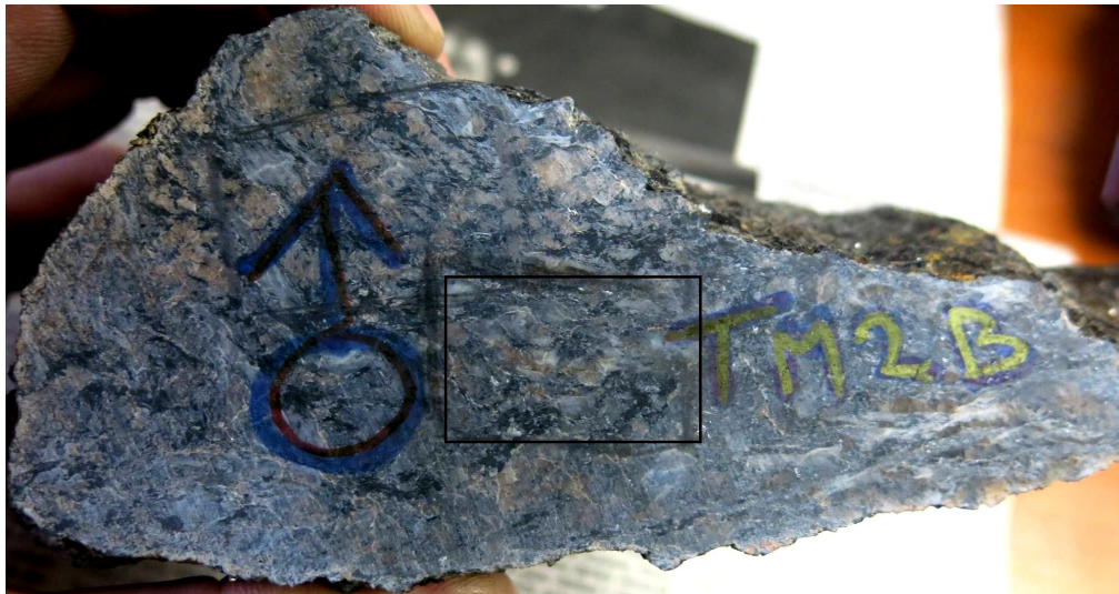
Obr. 18: Vzorek TM2 - B. Obdélník značí oblast, ze které byl vyhotoven výbrus.
