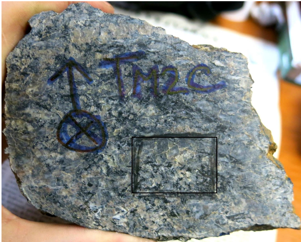
Obr. 19: Vzorek TM2 - C. Obdélník značí oblast, ze které byl vyhotoven výbrus.
