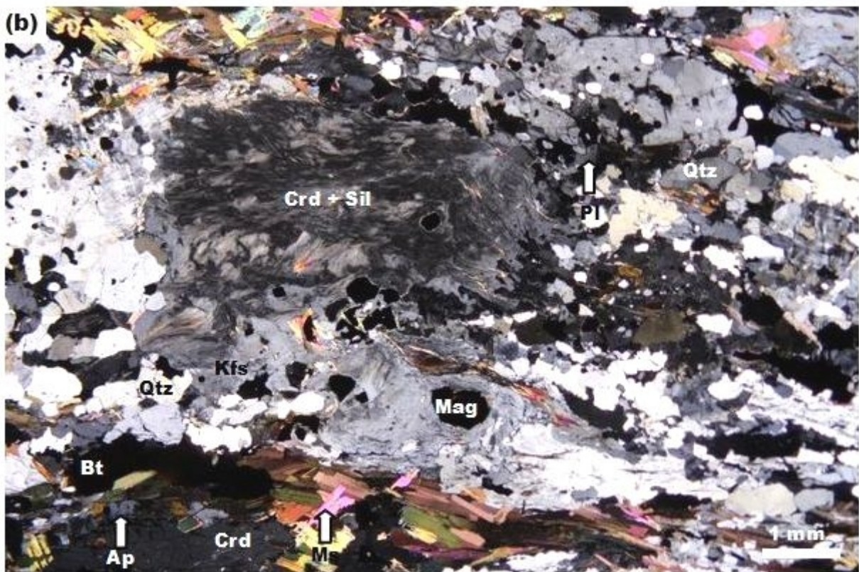
Obr. 30: Fotky z výbrusu TM3 – A2. a) pozorování při jednom nikolu; b) pozorování s dvěma nikoly.
