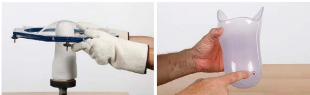
Obr 24: Výroba lůžka z Thermolynu a jeho úprava na stavbu zkušební protézy (7)
