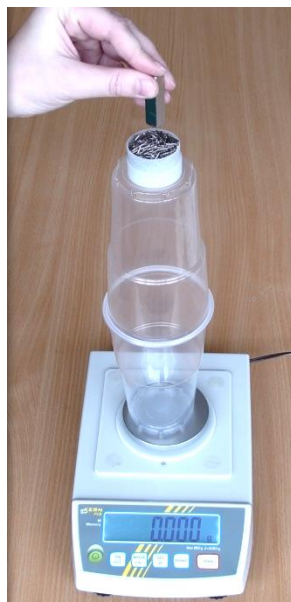
Obr. 5.3. Uspořádání experimentu pro demonstraci diamagnetismu a paramagnetismu
