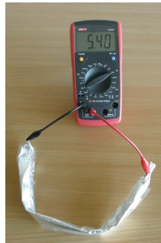
Obr. 1. Svitkový kondenzátor před svinutím (vlevo) a hotový kondenzátor připojený k měřáku kapacity – kapacita je 5,4 nF (vpravo)
