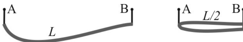
Obr. 4.9. Jak se změní proud, který teče do „přepůleného vodiče“ ze zdroje?
