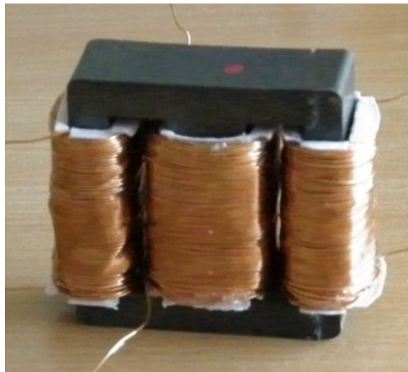
Obr. 5.12. Transformátor se dvěma sekundárními vinutími (krajní sloupky) a jedním primárním (prostřední sloupek)
