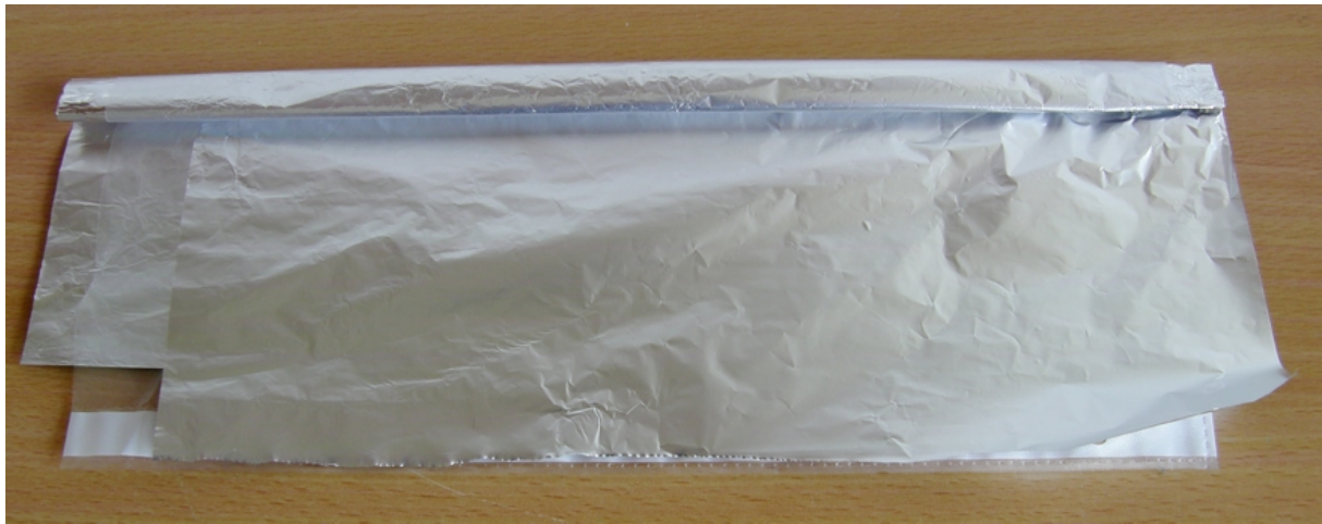
Obr. B3.3. Zčásti smotaný kondenzátor vyrobený ze dvou listů alobalu a eurofolie
